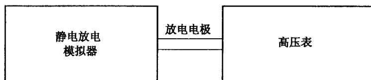
图 3 输出电压校准连接示意图
